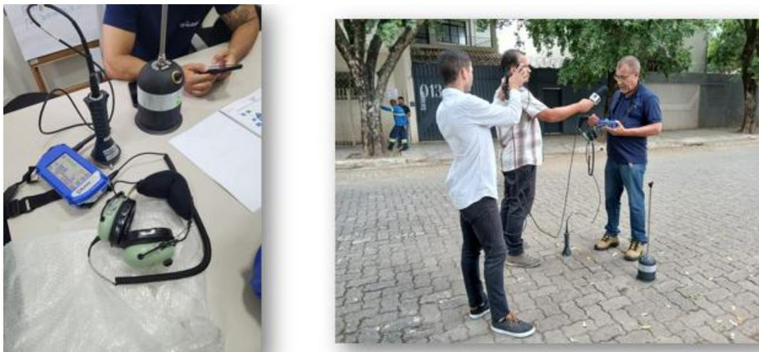
Figura 81 – Aquisição e Treinamento para utilização de Geofone
