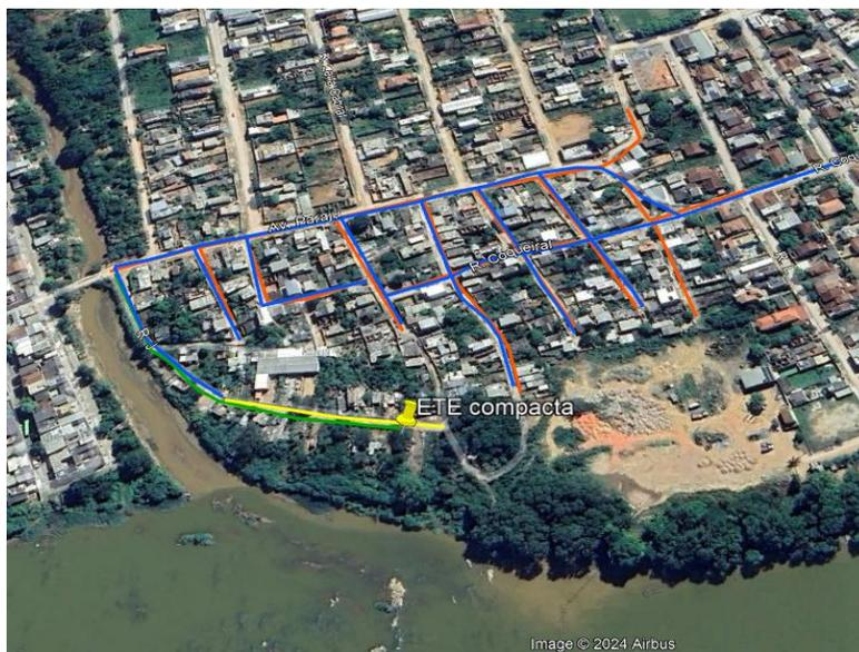
Figura 1 - Traçado de implantação de rede de água e esgoto no Vale Pastoril IV
