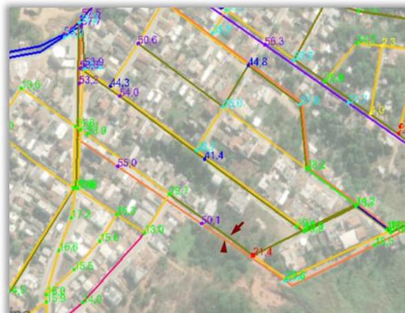
**Figura 83 – Estudo de setorização do sistema de abastecimento de água**
